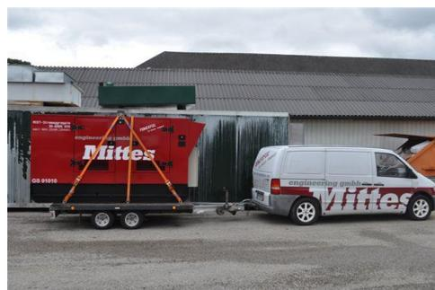
**Dauerleistung: 66 KVA - 53 KW – 95 A, 400/ 230 V cos 0,8**
